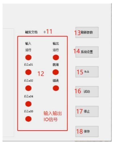
20 系统设置: (1) 校正尺寸 BOX 首先要确认最大的工作范围,缩放比例 XY 是,修改图形大小到你想要的范围,例如:最大工作范围为 10MM,BOX 校正 XY 都改为 10mm,再去修改数据类型为矩形,宽度高度都为 10mm,然后出光打出图形,量出图形是否为 10mm,不足的情况下,再去系统设置找到缩放比例,如果 XY 都不足的情况下,把缩放比例往上加一点,(2) 偏移量 XY 是让图形偏移的,(3) 最大工作距离 XY 是限制外面的宽度和高度的范围,设置里面设置了 5mm 那么外面的宽度和高度就限制成 5mm 的范围了,它不会超过这个范围了。(4) 最大工作速度也是做限制的,限制外面的速度,系统设置了 1000,那么外面的速度也就只能达到 1000 的速度,如果你设置了外面的速度为 2000,但他实际上也就是 1000
